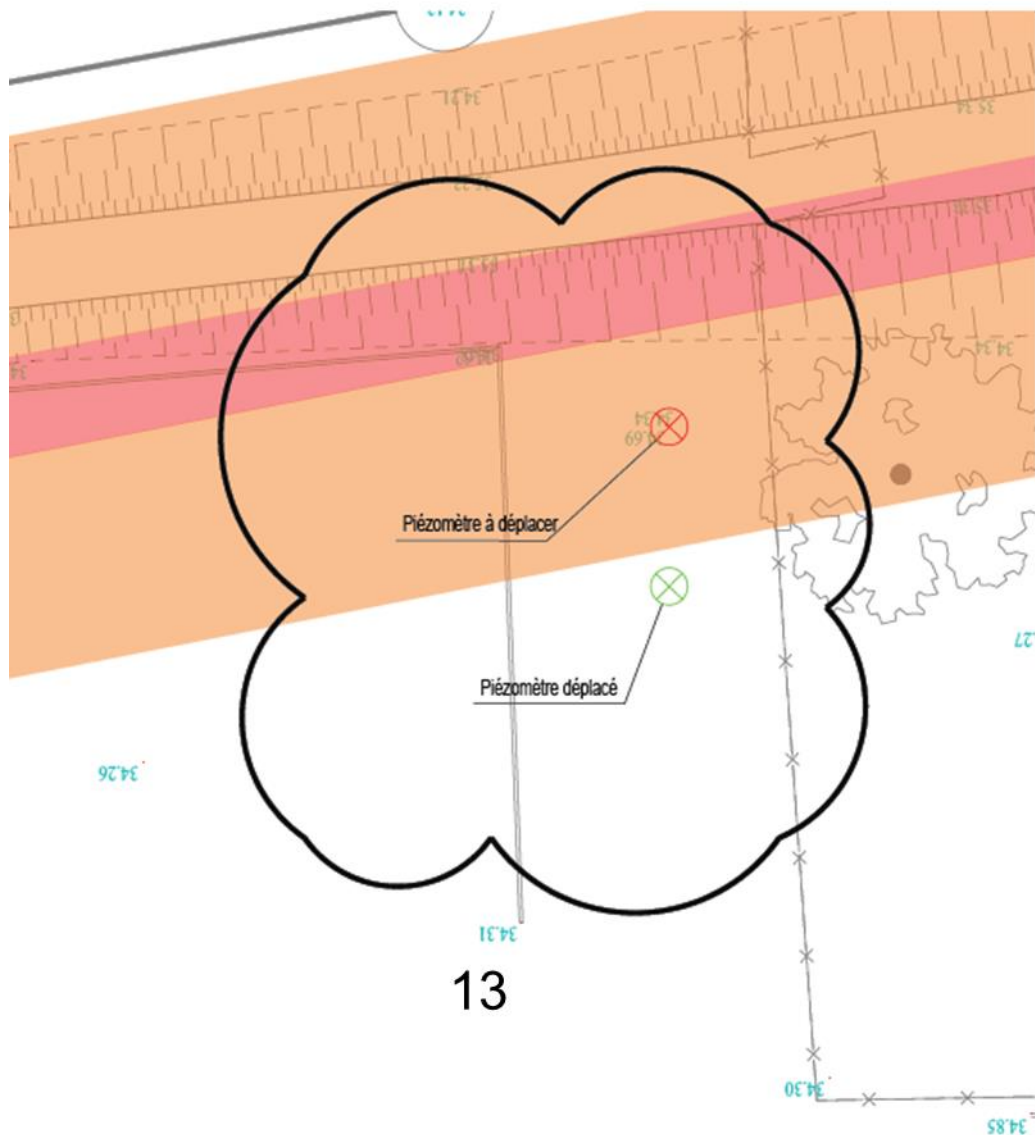
Figure 2-15 : Remblai se situant au-dessus d'un piézomètre existant
